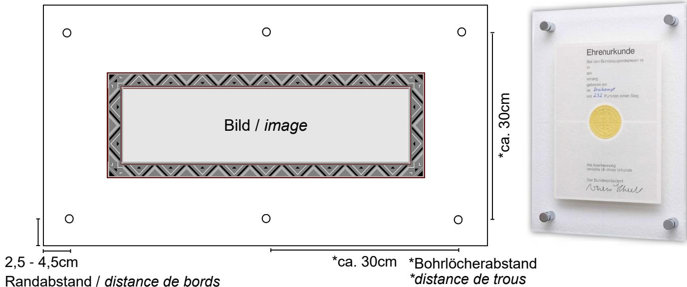
Der Plexiglasrahmen ist eine Art Sandwichkonstruktion. Das Bild wird zwischen zwei Plexiglasscheiben eingelegt. Auf der Rückseite des Rahmens befinden sich Abstandhalter, welche einen Abstand von 1cm zu Wand ergeben. Eine Lotfix-ähnliche Aufhängevorrichtung ist im Rahmen integriert.
